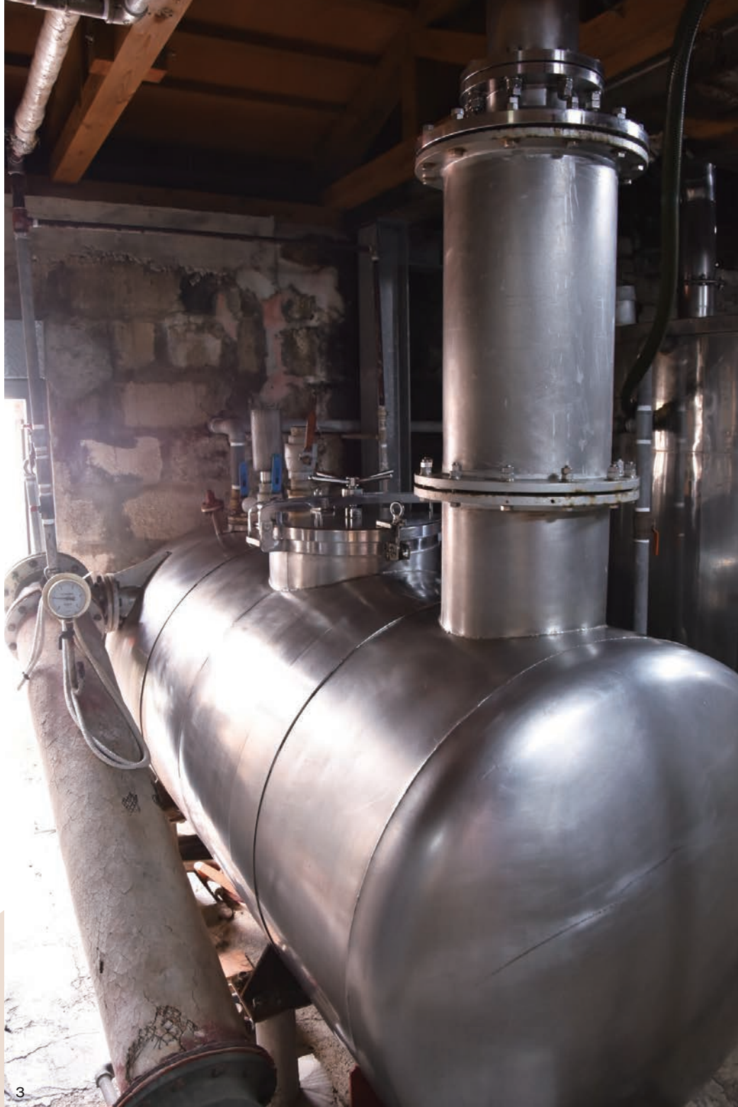
1：アルコール度数30%の「春雨」。ラベルには目出度い物が描かれている。2：独自の改良を加えた蒸留機器の前で泡盛造りについて説明する宮里徹さん。3：横型の常圧蒸留器。4：ステンレス製の発酵タンクは計13基ある。5：酒造は昔ながらの建物。
