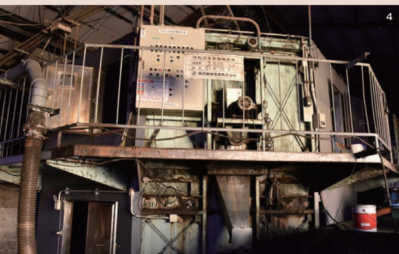
1：樽はバラタイズ式で貯蔵。2：久米仙の看板。3：ステンレス製の縦型蒸留器。これで泡盛、ウイスキーを造る。4：円盤式の自動製麹機。5：社長の比嘉さん(右)と、工場長の松村さん(左)。背後にあるのが、ステンレス製のマッシュタン。6：那覇市仲井真にある久米仙。貯酒タンクが林立する。
