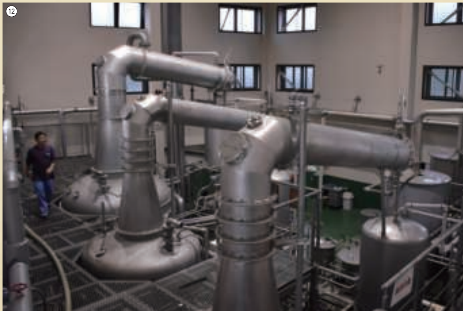
⑩焼酎の木桶蒸留器。今これを作る職人は一人しかいないという。⑪グレンファークラスのバルジ型のスチル。容量は約2万3000ℓ。すべてガス直火焚きだ。⑫佐多宗二商店の減圧・常圧蒸留器。すべてステンレス製。
