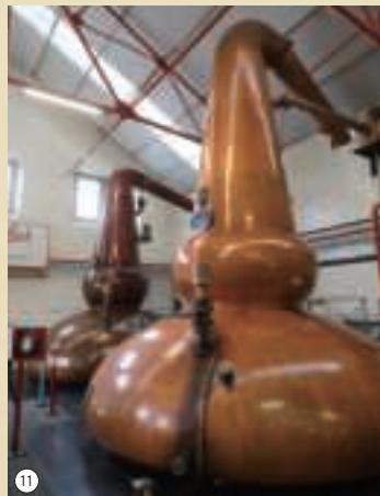
⑩焼酎の木桶蒸留器。今これを作る職人は一人しかいないという。⑪グレンファークラスのバルジ型のスチル。容量は約2万3000ℓ。すべてガス直火焚きだ。⑫佐多宗二商店の減圧・常圧蒸留器。すべてステンレス製。
