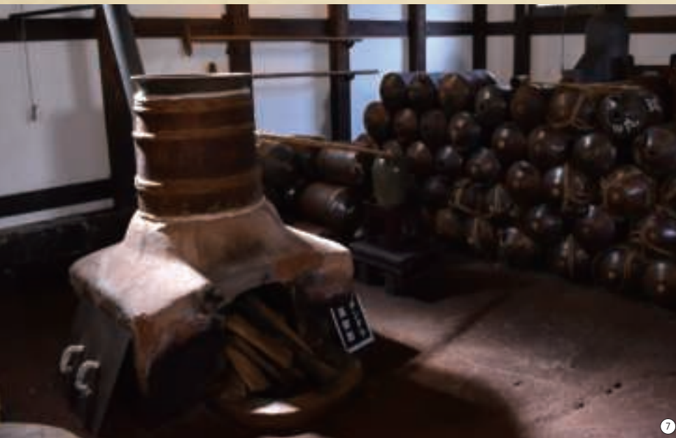
⑦田苑酒造に展示されていた古式の蒸留釜。もちろん直釜式だ。⑧カリラ蒸留所のポットスチル。ストレートヘッド型で間接加熱。⑨泡盛でよく見かける横型の蒸留器。モロミは外部で加熱する。
