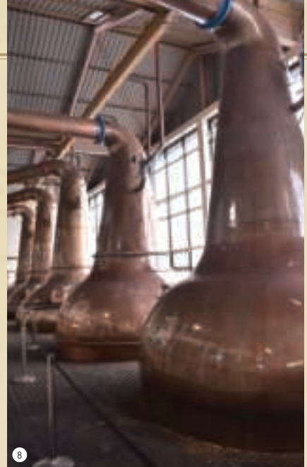
⑦田苑酒造に展示されていた古式の蒸留釜。もちろん直釜式だ。⑧カリラ蒸留所のポットスチル。ストレートヘッド型で間接加熱。⑨泡盛でよく見かける横型の蒸留器。モロミは外部で加熱する。
